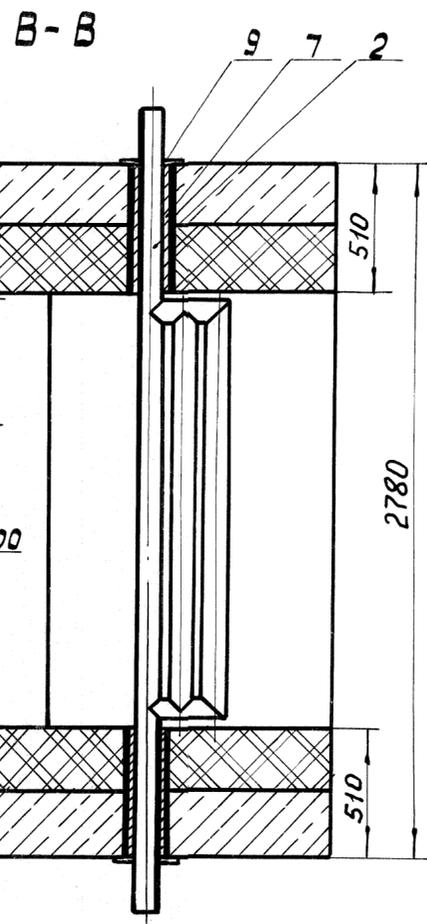
Схема подвода воды к подвижному пережиму.
